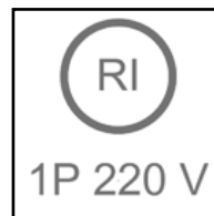
Relè interruttore 1P 10 A con bobina 220 V
