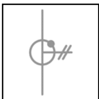
Trasformatore di corrente con un avvolgimento secondario con una presa
