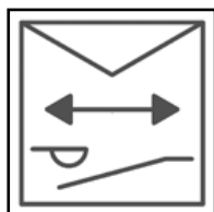
Avviatore diretto mediante contattore per 2 sensi di marcia
