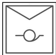
Avviatore-regolatore autotrasformatore
